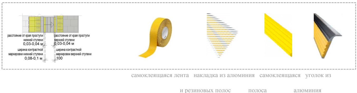
Рис. «Внешний вид контрастной маркировки на ступенях»
