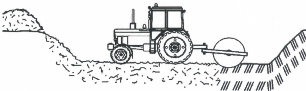
Рисунок 3. Операция уплотнения донного слоя грунта котлована сооружения, предназначенного для срочного захоронения трупов, усиленного модификатором свойств грунтов и минеральным вяжущим с помощью катка
