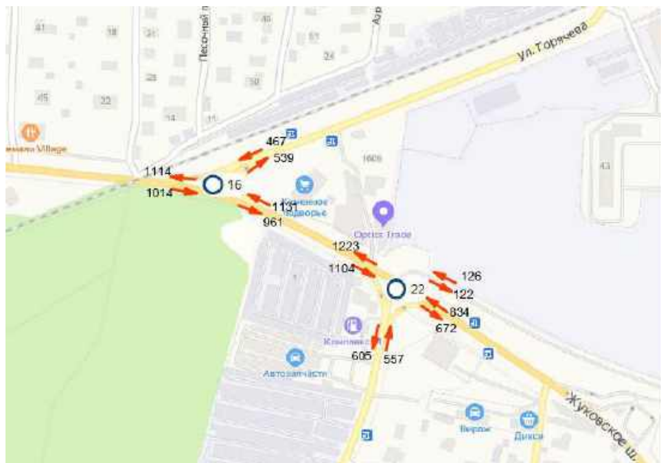
Рисунок 1.8.5 – Картограмма интенсивностей транспортных потоков по направлениям на участках УДС городского округа (транспортные узлы №16 и №22) в утренний час «пик»
