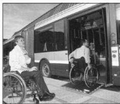
Рисунок 4.16.4 – Пример применения механической аппарели автобуса на посадочной площадке в габаритах места посадки инвалидов
