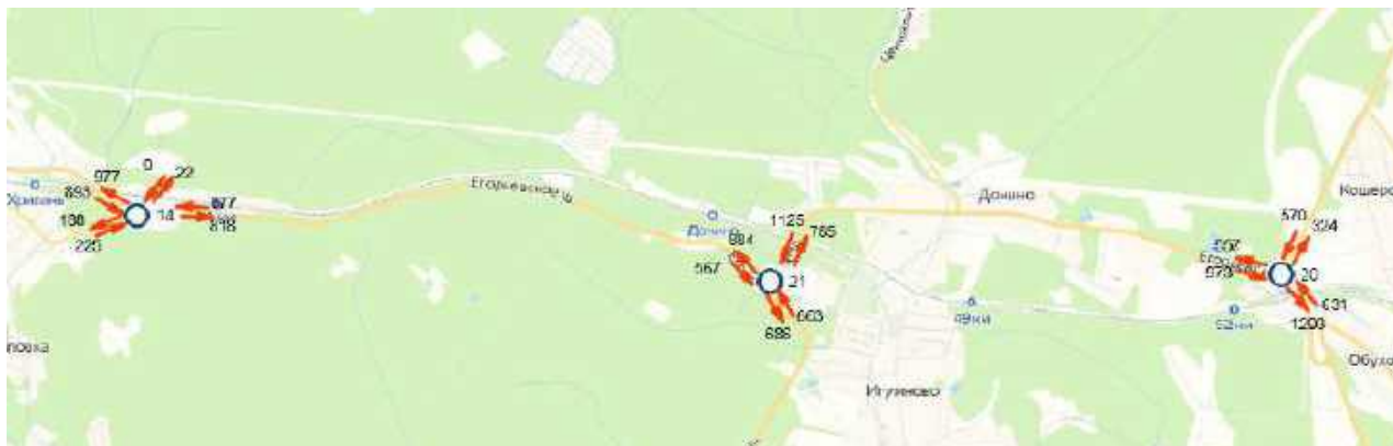
Рисунок 1.8.9 – Картограмма интенсивностей транспортных потоков по направлениям на участках УДС городского округа (транспортные узлы №14, №20 и №21) в утренний час «пик»
