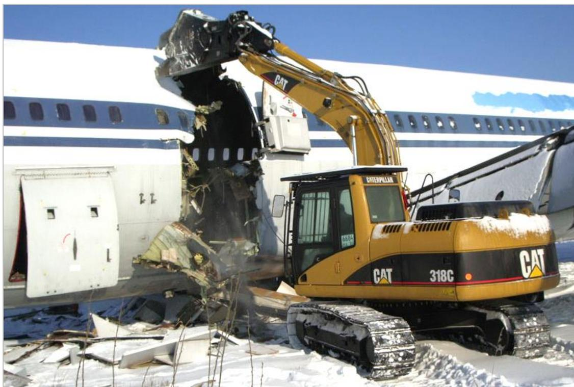
Рисунок 1.22 – Процесс утилизации авиационной техники на территории ООО «Авиавторресурс» в с. Верхнее Мячково
